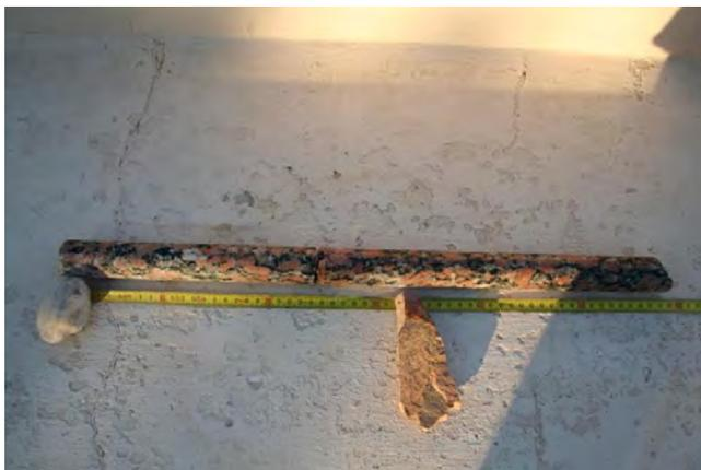
Le deuxième forage incliné environ à 60° recoupe la discontinuité à la profondeur de 0.17m et se prolonge jusqu'à 0.55m.
