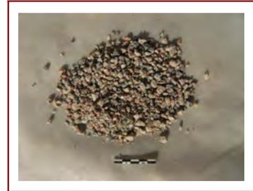
\*Le granite est trituré et tamisé à travers une maille de 2 mm. Les grands fragments qui ne passent pas sont éliminés et le reste est mélangé avec la fraction inférieure à 2 mm. Le tout est à nouveau tamisé à travers une maille fine (passoire orange) pour éliminer la poudre de granite qui donne une teinte grise au mortier.
